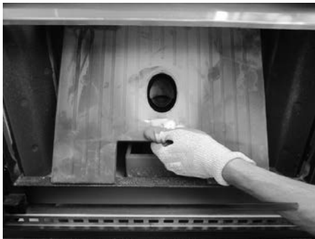
Fig. 37 - Remoção ferro fundido central
