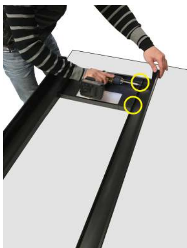
Fig. 22 - Fixação do montante
