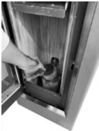
Fig. 31 - Remoção do braseiro
