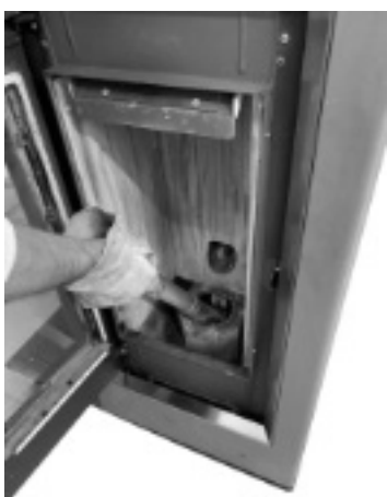
Fig. 33 - Limpeza do compartimento do braseiro
