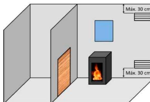
Figura nº11 - Esquema orientativo para grelhas de arejamento
