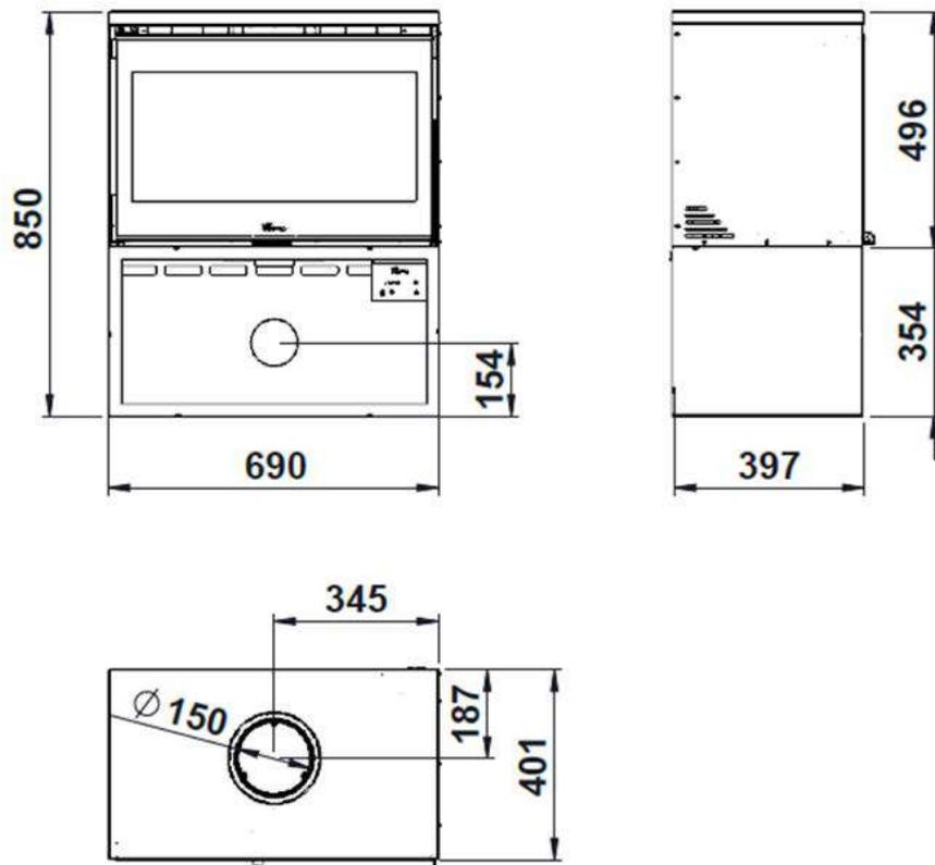
Figura n<sup>o</sup>1 - Dimensões em mm do aparelho PARIS 700
