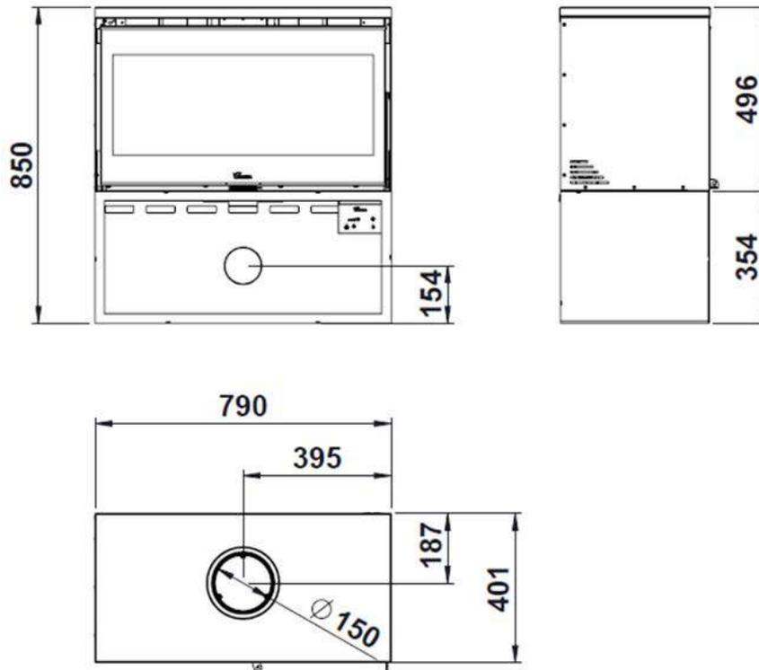
Figura nº5 - Dimensões em mm do aparelho PARIS 800
