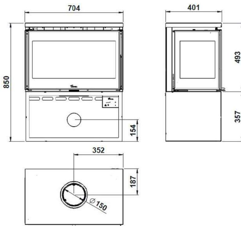
Figura n<sup>o</sup>2 - Dimensões em mm do aparelho PARIS 700 CLID
