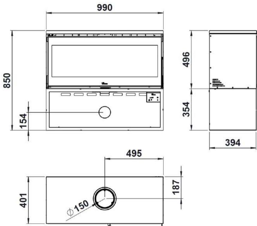
Figura nº9 - Dimensões em mm do aparelho PARIS 1000
