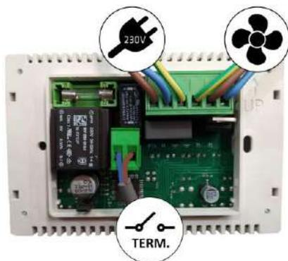
Figura nº14 - Ligações a realizar no potenciômetro
