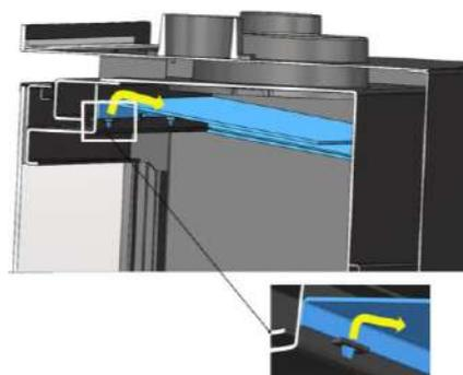
Figura n°23 - Desmontagem defletor superior
