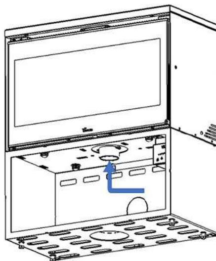
Figura nº12 - Condução de ar para câmara de combustão
