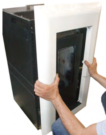
Fig. 50 - Remoção painel frontal
