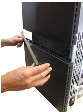
Fig. 53 - Remoção painel central
