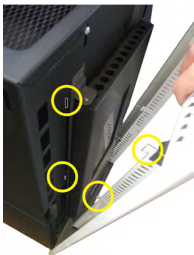
Fig. 18 - Montagem painel frontal
