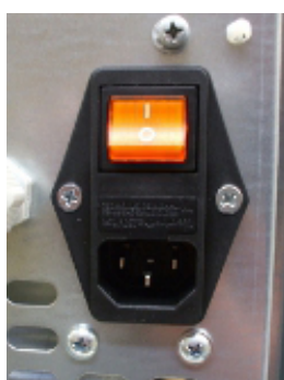
Fig. 21 - Tomada elétrica com interruptor geral
