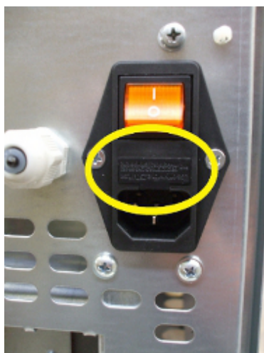
Fig. 58 - Porta com fusíveis a remover
