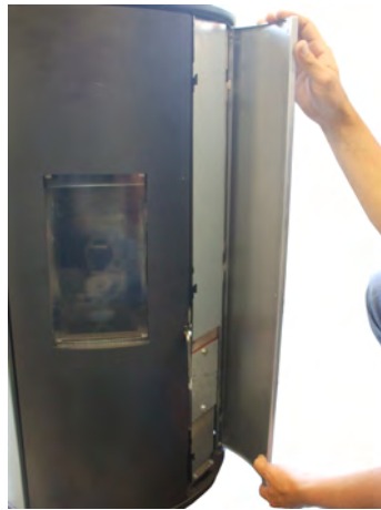
Fig. 44 - Remoção dos painéis
